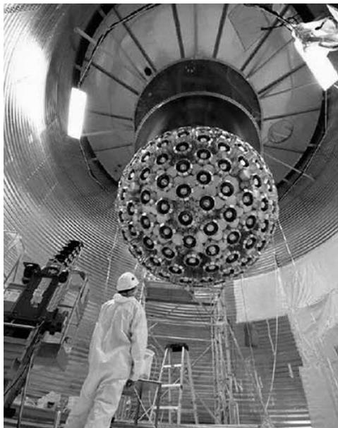
Detector de materia oscura instalado en el SNOLAB.
